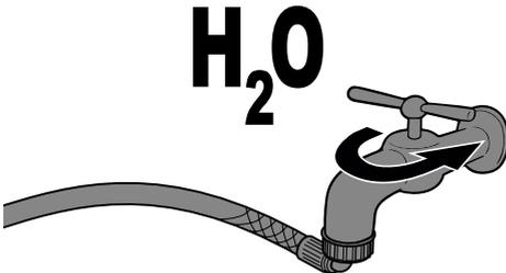
Für das erste Befüllen der Maschine müssen im Wassertank 2 Liter Wasser eingegeben werden. Dieser Vorgang muss bei ausgeschalteter Maschine vor der ersten Maschineneinschaltung erfolgen.
