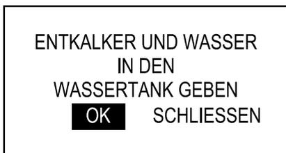
In den Wassertank 250 ml Entkalkungsmittel und 750 ml Wasser füllen. „OK“ markieren und mit „OK bestätigen“. Daraufhin wird folgende Ansicht angezeigt:
