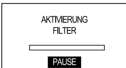
Durch Druck der Taste „OK“ kann der Vorgang unterbrochen werden. Nach dem Vorgang „Verwaltung Wasserfilter“ schließt die Maschine das Menü von selbst. Um aus dem Menü mit den Tasten „Up“ oder „Down“ bis zum Menüpunkt „Schließen“ scrollen. Anschließend den Wassertank erneut bis zum Füllstand MAX mit frischem Trinkwasser füllen. Auf der Ansicht Maschine betriebsbereit erscheint das Symbol Wasserfilter mit 100% und gibt damit an, dass ein Filter installiert wurde.
