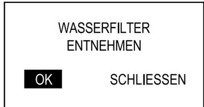
Den Tank aus der Maschine herausnehmen und leeren. Den Kalkschutzfilter herausnehmen. „OK“ markieren und mit „OK bestätigen“. Daraufhin wird folgende Ansicht angezeigt:
