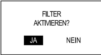
„NEIN“ markieren und mit „OK“ bestätigen. Programmierung verlassen. Den kleinen weißen Filter wieder einsetzen. Anschließend den Wassertank erneut bis zum Füllstand MAX mit frischem Trinkwasser füllen.
